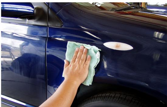
水で濡らし、固く絞ったマイクロファイバークロスで少し力を入れながら拭き上げ光沢を出し完成。
