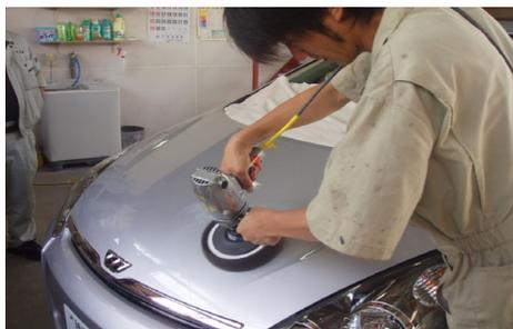
コンパウンドを使用しボディー表面に残ったワックスや劣化した塗膜を除去する。
